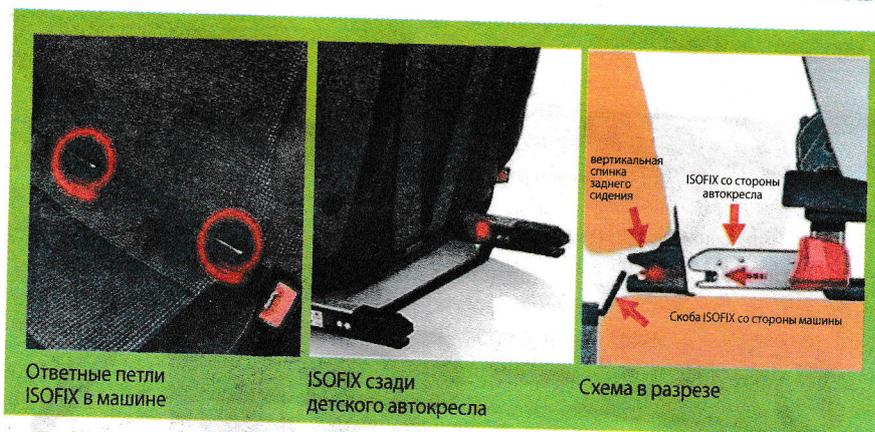
Крепления ISOFIX как самостоятельные используются для автокресел групп 0+/1 (до 18 кг), в которых ребёнок фиксируется ремнями безопасности автокресла, которое, в свою очередь, крепится к автомобилю непосредственно системой ISOFIX.
